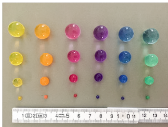
Abbildung 1: Gelkugeln in verschiedenem Quellzustand. Maximale Quellung dieser Kugeln nach ein paar Stunden, farbabhängig.
