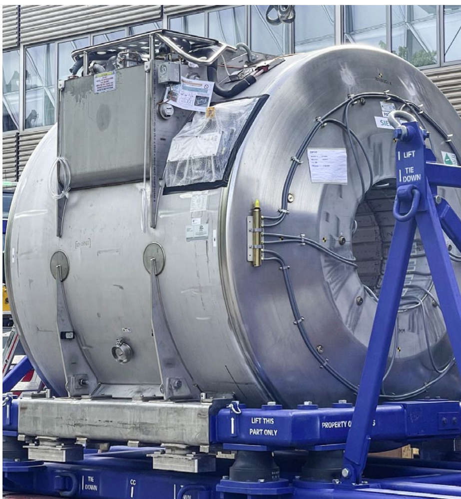
Abbildung 1: 7T-MRT-Magnet zur klinischen Anwendung.
